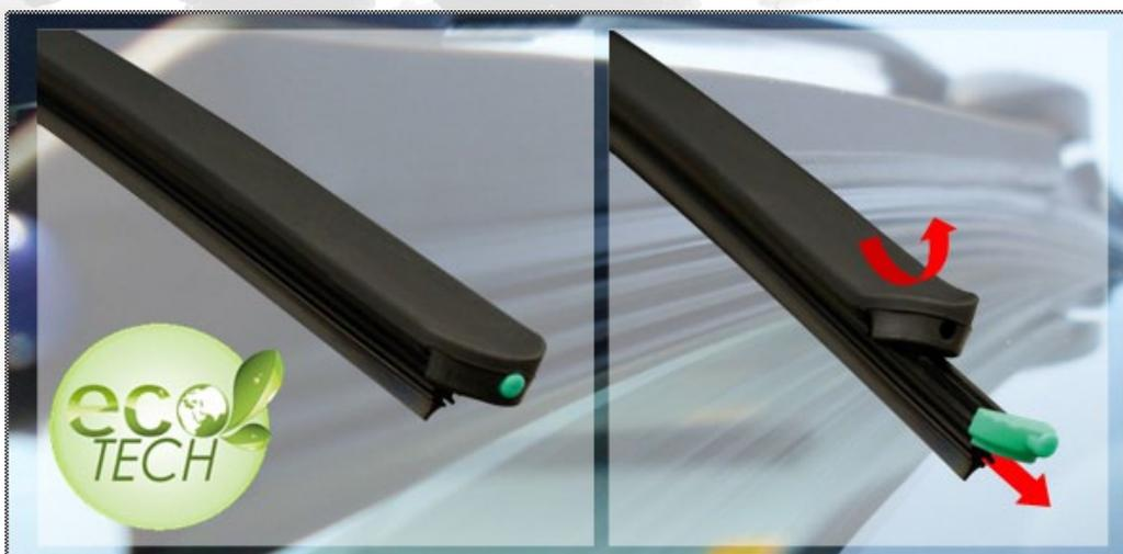
Комплект этой уникальной щетки включает в себя: саму щетку с уже установленным всепогодным лезвием, дополнительный зимний картридж (сменное лезвие для использования в условиях сильных снегопадов и холодных температур), 4 адаптера. Щетка представлена в размерах от 400мм-650мм (16»-26»).
